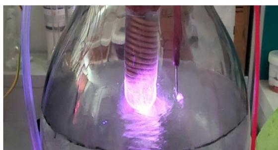
*Figura 1. Sorgente plasma freddo atmosferico durante il trattamento di 6 L di acqua di rubinetto.*
